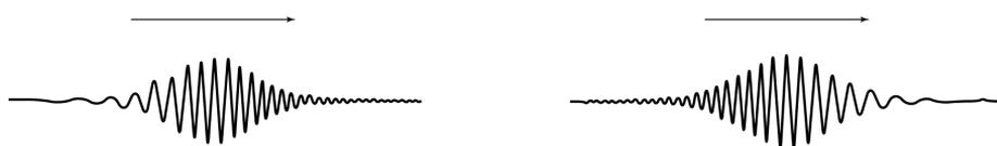
Рис. 90. Компрессия импульса с положительной (справа) и отрицательной (слева) частотной модуляцией
