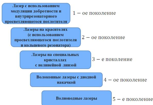
Рис. 86. Поколения лазеров коротких и сверхкоротких импульсов
